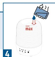
Vorsichtig Wasser einfüllen – kalkfreies/distilliertes Wasser verwenden!
