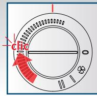
Temperaturregler langsam im Uhrzeigersinn drehen bis «Click» zu hören ist. Danach ist Temperatur auf diesem Level fixiert.
