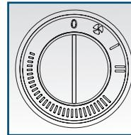
2 Wärmegrade: 1000W / 2000W mit Kaltluftstufe
