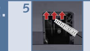
2. Rückstände beim Pulverschacht und Oberseite mit Reinigungsbürste entfernen
