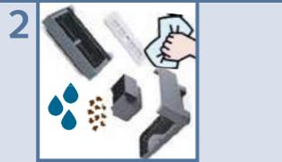
2. Tropfschale leeren, Gitter und Tropfschale feucht abwischen, Tresterbehälter leeren, Restwasserbehälter und Tresterbehälter reinigen und gut trocknen
