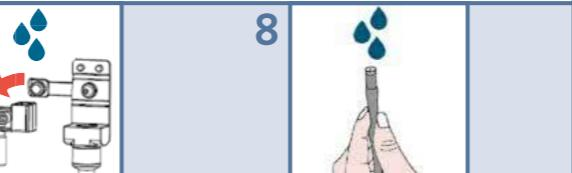
Düse in zwei Teile zerlegen und mit Seifenwasserasser reinigen
