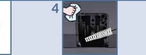
Innenraum des Gerätes mit Reinigungsbürste/Tuch reinigen
