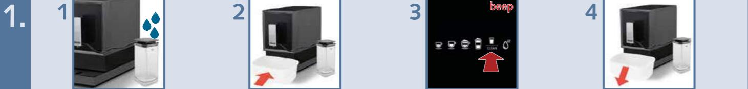
Milchbehälter reinigen und mit frischem Wasser füllen
