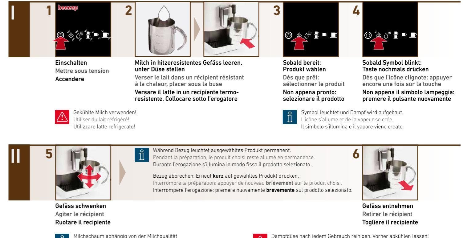
Dampfdüse nach jedem Gebrauch reinigen. Vorher abkühlen lassen!
