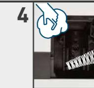
**4** Innenraum des Gerätes mit Reinigungsbürste/Tuch reinigen
