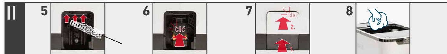
**5** Rückstände beim Pulverschacht und Oberseite mit Reinigungsbürste entfernen
