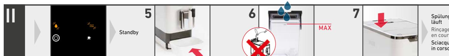
Entkalkung Schritt 1 abgeschlossen (nach ca. 15 Min.)
