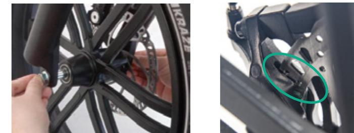
5.3 Przykręć lewą i prawą nakrętkę dedykowanymi kluczami i upewnij się, że koło zostało odpowiednio przymocowane do przedniego widelca.
