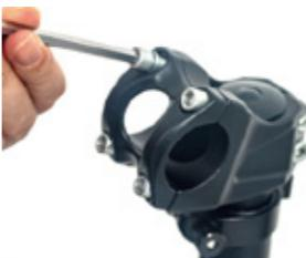
4.2 Montieren Sie den Lenker am Lenkervorbaus und schrauben Sie die vier Schrauben mit einem passenden Schlüssel wieder fest. Stellen Sie bei der Montage den Lenker in einem geeigneten Winkel ein, damit das Fahrrad bequem bedient werden kann.
