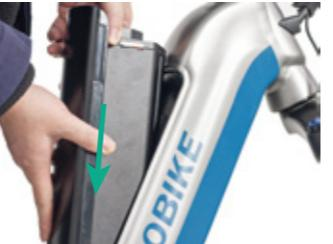
10.2 Wciśnij baterię do komory tak aby została solidnie umiejscowiona.
