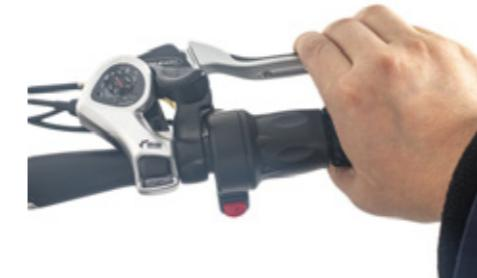
(8) Drücken Sie den roten Knopf und drehen Sie den Gashebel, um das Fahrrad zu fahren.
