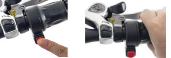
(9) Schalten Sie die Gangschaltung mit den Tasten "+" und "-" um, um die Geschwindigkeit an die unterschiedlichen Straßenverhältnisse anzupassen.
