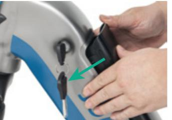
10.3 Drehen Sie den Schlüssel im Uhrzeigersinn bis zum Ende, dann ist die Batterie verriegelt.
