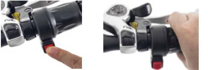
(9) Zmieniaj poziomy przerzutki za pomocą dźwigni "+" i przycisku "-", aby dostosować bieg do warunków terenu.
