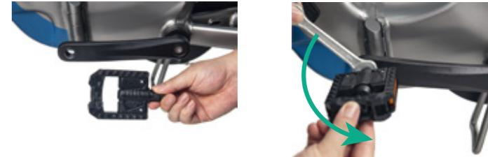
8.3 Schrauben Sie die rechte Pedalschraube mit einem Schraubenschlüssel im Uhrzeigersinn in die rechte Kurbel.
