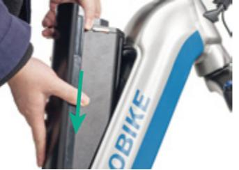
10.2 Drücken Sie die Batterie ein wenig fest, bis sie in das Batteriefach geschoben wurde.
