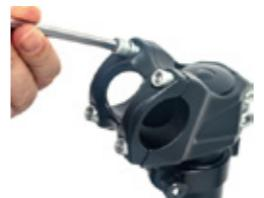
4.2 Zamontuj kierownicę na wsporniku i przykręć cztery śruby. Podczas montażu ustaw kierownicę pod odpowiednim kątem, aby rower mógł być komfortowo obsługiwany.
