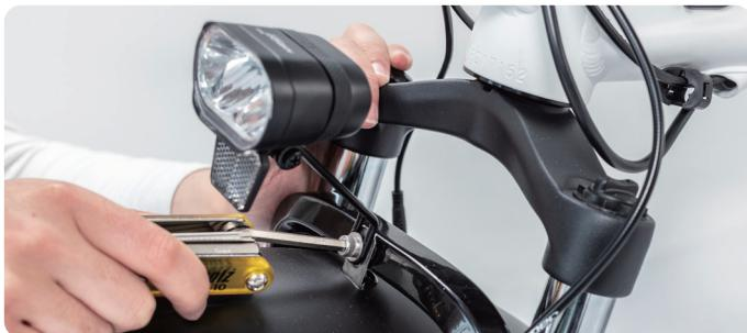
5.2 Ustaw lampkę pod odpowiednim kątem, aby oświetlała drogę przed Tobą. Sposób ustawiania lampki: Poluzuj śrubę regulacyjną za pomocą śrubokręta krzyżakowego, ustaw kąt nachylenia lampki, a następnie dokręć śrubę.
