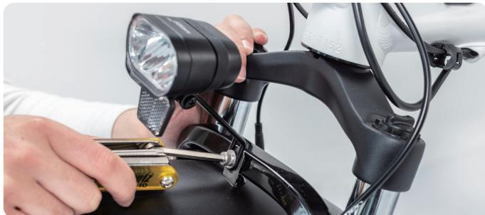
5.2 Ajuster le phare à un angle approprié de la façon suivante : desserrer la vis de réglage avec un tournevis cruciforme, ajuster l'angle d'inclinaison du phare à la meilleure position, puis serrer le boulon.
