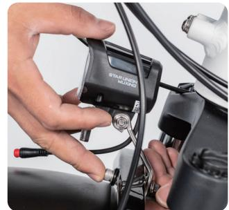
5.2 So stellen Sie den Scheinwerfer auf den richtigen Winkel ein: Lösen Sie die Einstellschraube mit einem Kreuzschlitzschraubendreher, stellen Sie den Neigungswinkel des Scheinwerfers auf die beste Position ein und ziehen Sie die Schraube wieder fest.
