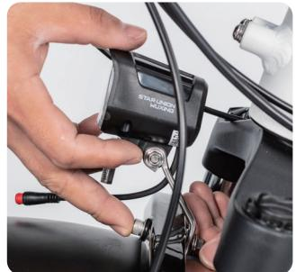
5.2 Ajuster le phare à un angle approprié de la façon suivante : desserrer la vis de réglage avec un tournevis cruciforme, ajuster l'angle d'inclinaison du phare à la meilleure position, puis serrer le boulon.
