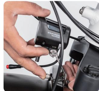
5.2 Ustaw lampkę pod odpowiednim kątem, aby oświetlała drogę przed Tobą. Sposób ustawiania lampki: Poluzuj śrubę regulacyjną za pomocą śrubokręta krzyżakowego, ustaw kąt nachylenia lampki, a następnie dokręć śrubę.
