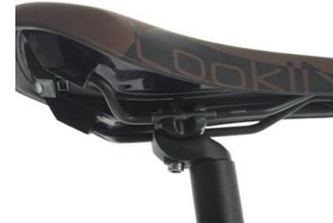
3. Tout en maintenant le siège dans la position désirée, utilisez une clé hexagonale de 6 mm pour serrer fermement le boulon de réglage de la selle.
