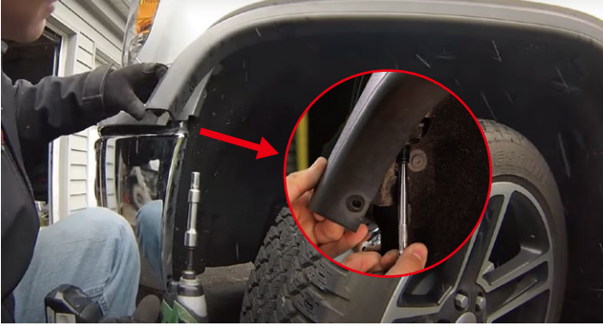
7. Remove 7mm bolt.
