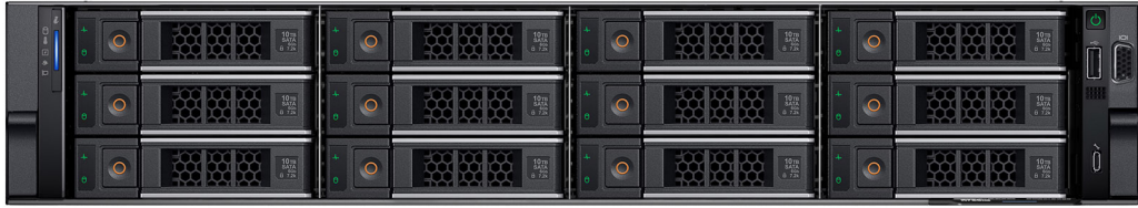
그림 4 . 12개의 3.5인치 드라이브 시스템의 전면
