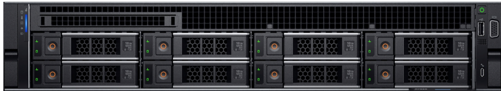
그림 5 . 8개의 3.5인치 드라이브 시스템의 전면
