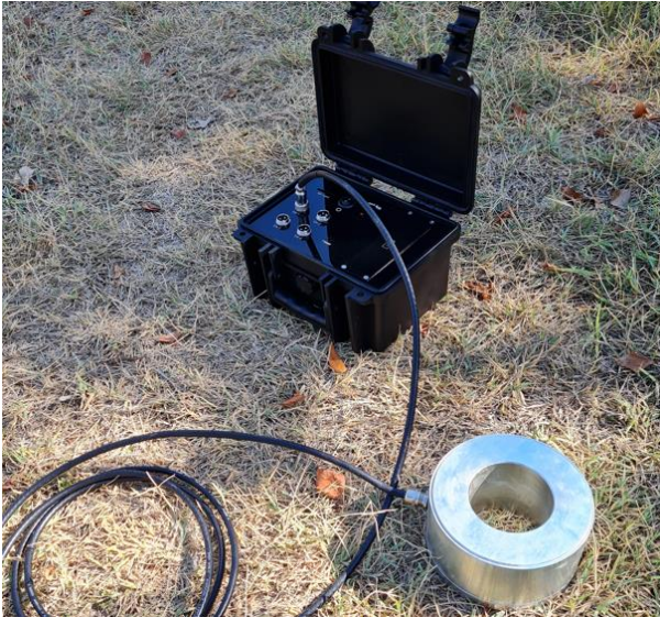
GeoAnts Ankraj Yük Hücresi ve GeoAnts Saha Veri Toplama Ünitesi
