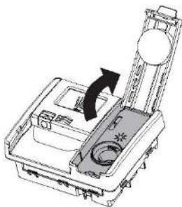
Si se ilumina el indicador del abrillantador, llene el dispensador correspondiente.
