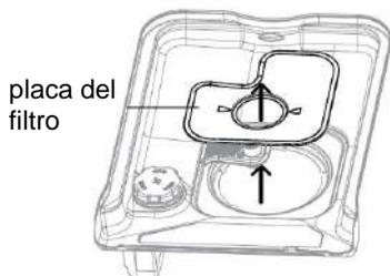
Con el filtro retirado, levante la placa del filtro hacia arriba y hacia fuera.
