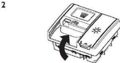
Retire el exceso de detergente y cierre la tapa. Hará clic cuando esté bien colocada. Si es necesario, añada detergente adicional al compartimento del prelavado situado encima del dispensador.
