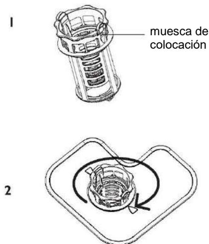
Alinee la tapa del filtro con la muesca de la base del filtro. Asegúrese de que la estructura de la hebilla está en su sitio.
