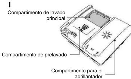
Compruebe que el dispensador esté vacío y seco. Añada detergente en polvo o pastillas al dispensador de detergente.
