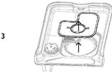
Retire el filtro de drenaje y la placa del filtro. Utilice una esponja para eliminar cualquier resto de agua de debajo antes de reemplazar.
