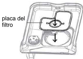
Coloque la placa del filtro debajo de los clips de ubicación en la parte trasera del desagüe y empújela con firmeza hasta que quede en su sitio. Asegúrese de que la placa del filtro está a ras de la base del lavavajillas.
