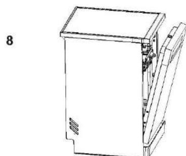
Después del lavado, la puerta se abrirá un poco de forma automática para ayudar con el secado.\*
