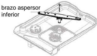
Para retirar el brazo aspersor inferior, sáquelo de la base del lavavajillas. Enjuague bien el brazo aspersor con agua corriente y vuelva a colocarlo. Asegúrese de que el brazo gira libremente cuando vuelva a montarlo.
