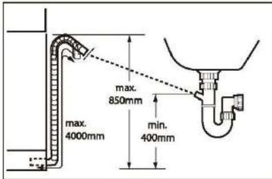
Fije correctamente la manguera de drenaje de agua a la tubería. La manguera debe alcanzar una altura comprendida entre 400 y 850 mm por encima de la línea inferior del aparato.
