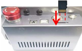
1、 Bevor Sie die Graviermaschine verwenden, stecken Sie bitte die TF-Karte entlang der gestrichelten Linie in den Kartenschlitz der Steuerbox. Wenn die TF-Karte nicht eingesteckt ist, kann die Graviermaschine nach dem Aufrufen der Betriebsanzeige nicht betrieben werden. Achten Sie beim Einlegen der Karte auf die Vorder- und Rückseite der TF-Karte. Stecken Sie die Karte in den Kartenschacht auf der Rückseite (siehe Abbildung für korrektes Einsetzen)
