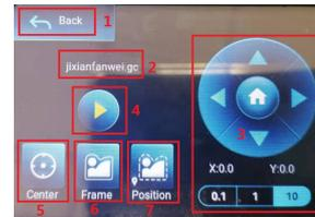
**4、 Dies ist die Gravurvorbereitungsschnittstelle, die Gravierstart, X/Y-Achsenbewegung, Mittelpunkt, Konturscannen und Positionierungsoperationen ausführen kann.**
