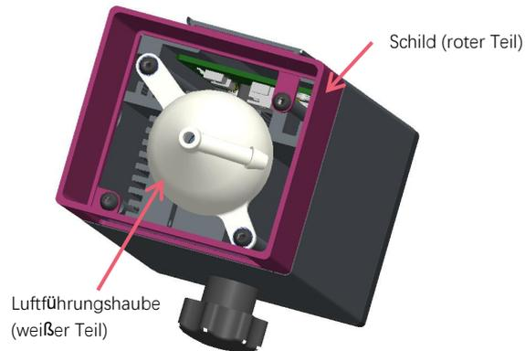
Beim Gravieren oder Schneiden von Holz und anderen Gegenständen wird viel Rauch erzeugt. Achten Sie darauf, die Luftführungshaube und die rutschfeste Abdeckung zu reinigen, da sich viel Staub darauf ansammeln kann, insbesondere wenn Sie mit mehr als 50 % des Materials arbeiten Laserleistung.
