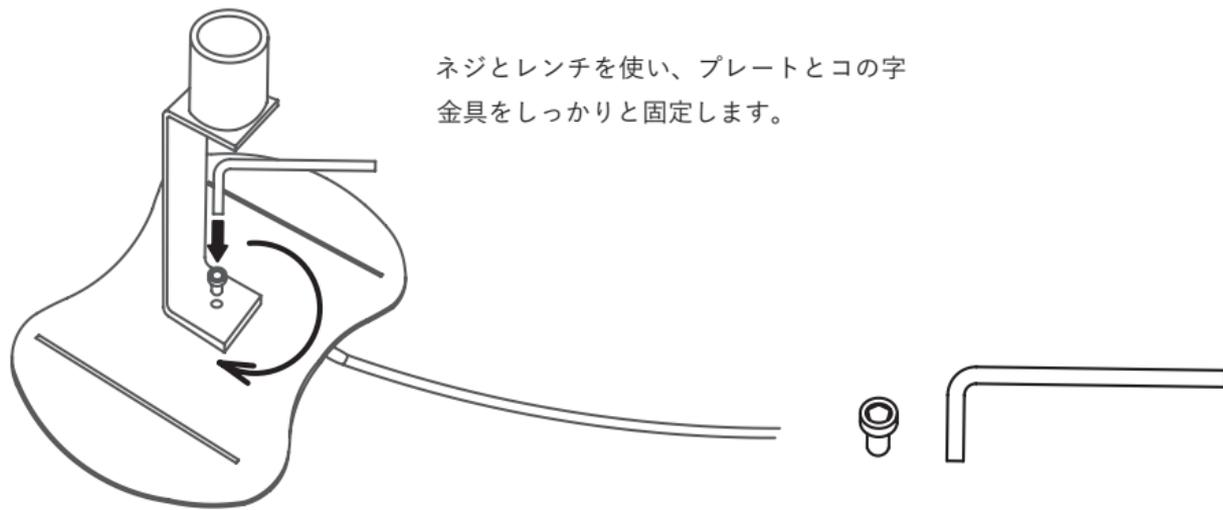
ネジとレンチを使い、プレートとコの字金具をしっかりと固定します。
