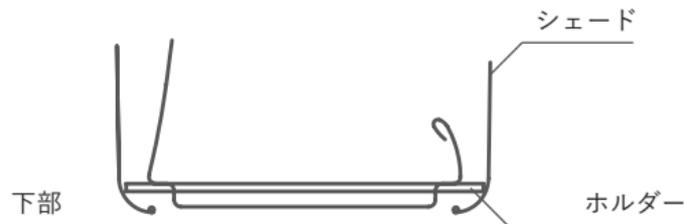
シェード上の開口部にホルダーを差し込み、下部をプレートに引っ掛けて取り付けます。
