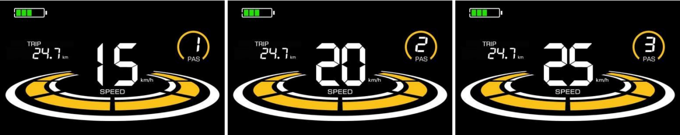
Figure 5-5 PAS level display interface
