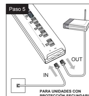
Conecte el teléfono/módem/enrutador/fax a la protección contra sobretensiones secundaria.
