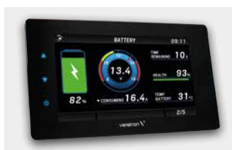
Schermata Intelligent Battery Sensor (IBS) per tenere sotto controllo le riserve di energia.
