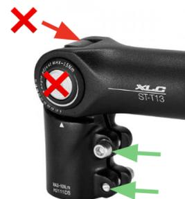
L'**inclinaison du guidon** est parfois modifiée pour protéger l'écran durant le transport. Les outils vous sont fournis le cas échéant. Pour modifier l'inclinaison, identifiez la ou les vis de serrage et serrez-les.
