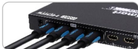
2. Schließen Sie die Ausgangsanschlüsse mit 4 HDMI-Kabeln an die Anzeigeräte an.
