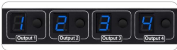
Die Digitalanzeige zeigt die Nummer des Eingangsanschlusses an, der durch den aktuellen Ausgangsanschluss ausgewählt wurde, und die Taste neben jeder Digitalanzeige ist die Eingangsauswahl-taste.
