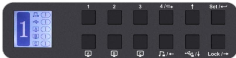
Wenn Sie die Taste an der Vorderseite oder die IR-Fernbedienung zur Steuerung des KVM verwenden, wird auf dem LCD-Display die gewünschte Aktion abgefragt und der Befehl entsprechend Ihrer Operation ausgeführt. Die LCD-Anzeige in der Abbildung oben ist die Hauptschnittstelle.
