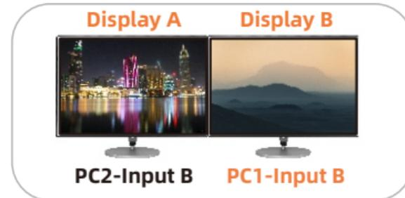
Wenn verschiedene PCs auf verschiedenen Monitoren angezeigt werden, können Sie mit einem Doppelklick auf die Rechts-[Alt]-Taste auf der an den KVM angeschlossenen Tastatur den Fokus zwischen den verschiedenen PCs umschalten.
