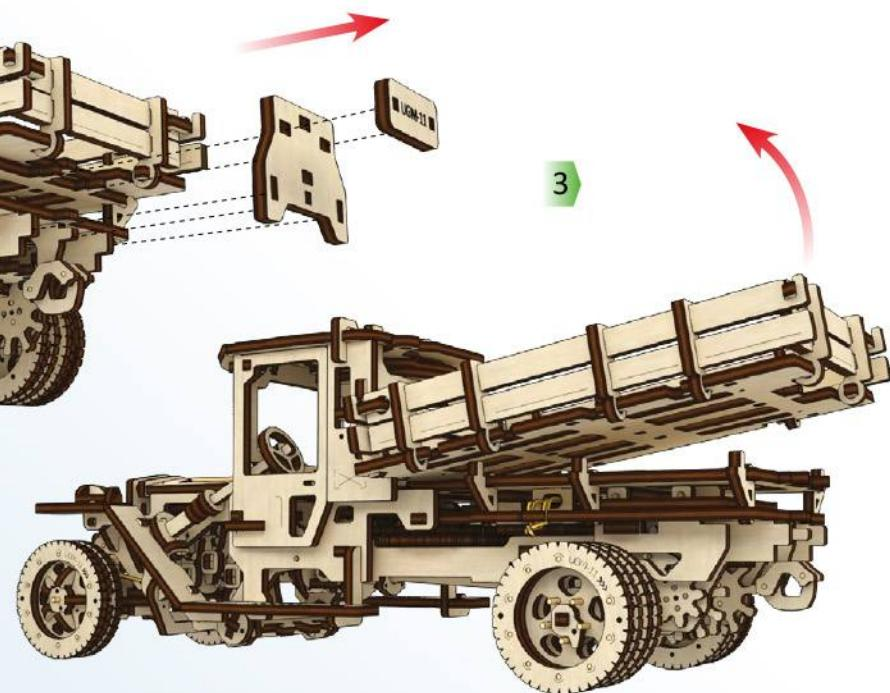
ENG Carefully remove the car body. UKR Акруатно зниміть кузов. DEU Entfernen Sie vorsichtig den Pritschenaufbau. FRA Retirez délicatement la carrosserie du camion. POL Delikatnie zdjąć karoserię. SPA Extraiga cuidadosamente el cuerpo del coche. ITA Rimuovere il cassone con la dovuta calma. RUS Аккуратно демонтируйте кузов. JAP 注意しながら車の本体をお外してください。
