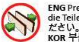
ENG Press the parts as far as they will go. UKR Притисніть деталі до упору. FRA Pressez les pièces à fond. DEU Drücken Sie die Teile bis zum Anschlag. SPA Pulse para detener las piezas. ITA Stingere bene i componenti. JAP 部品をできる限り押してください。CHI 用力紧密结合部件。POR Pressione as peças o máximo possível. POL Przyciśnij element, aż do oporu. KOR 부품을 양쪽에서 눌러서 고정해 주세요.
