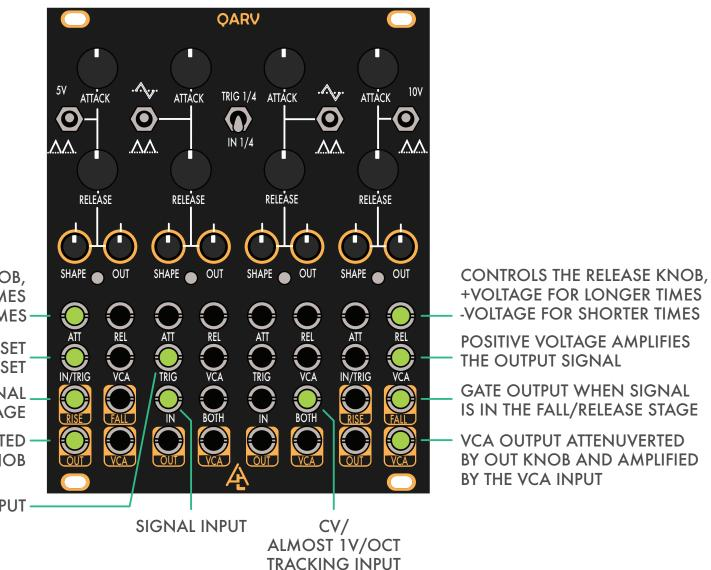
CONTROLS THE ATTACK KNOB, +VOLTAGE FOR LONGER TIMES -VOLTAGE FOR SHORTER TIMES-
