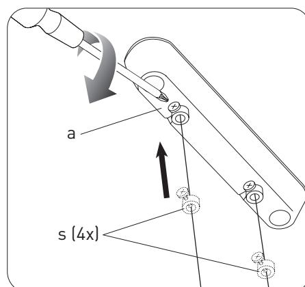
Al termine delle operazioni di regolazione, posizionare e bloccare i 4 serracavi (**s**) in battuta su ciascun supporto (**a**) per evitare oscillazioni della struttura della lampada.
