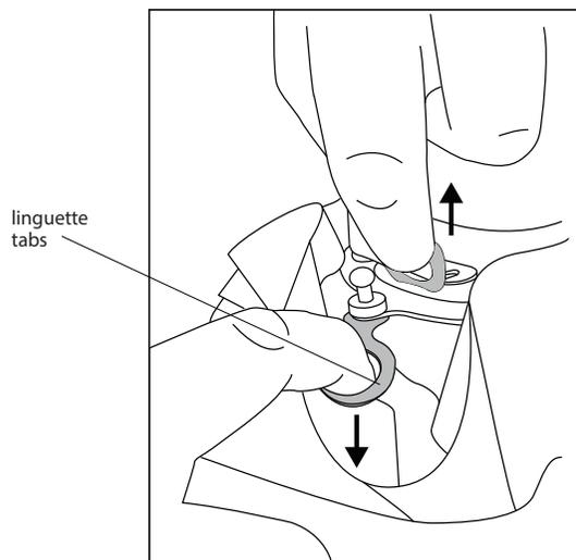
Per staccare il diffusore , aprire il fermo di sicurezza ed utilizzare il sistema di attacco magnetico utilizzando sempre le linguette come mostrato in figura.
