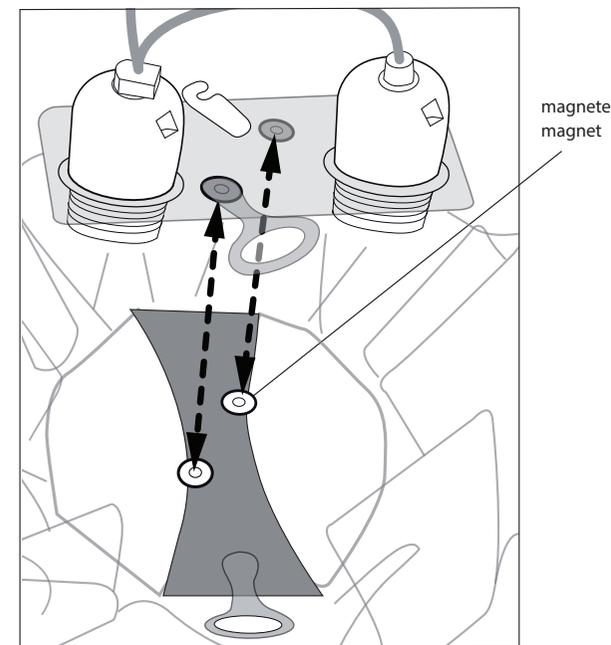
Agganciare la parte inferiore del diffusore a quella superiore fissata al soffitto facendo aderire i magneti come mostrato in figura.
