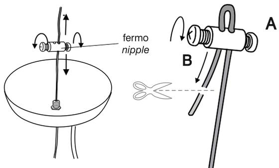
Svitare il fermo. Regolare la lunghezza del cavo in acciaio facendo scorrere il fermo. Avvitare la vite (A), inserire il cavo all'interno del foro e serrare la vite (B). Tagliare il cavo in eccesso.
