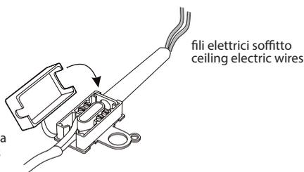
**F** Rimettere in sede il tubicino e i cavi avvitati tramite il connettore all'interno della loro sede nella scatola. Chiudere il coperchio a pressione e re-inserire il tutto all'interno della coppetta.
