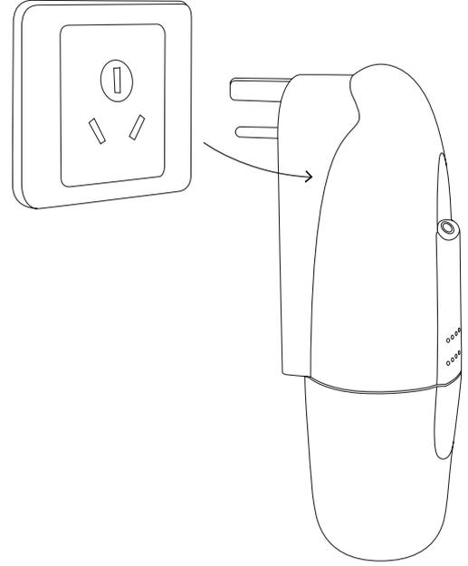
4 قم بتوصيل القابس بالتيار الكهربائي وتشغيل مفتاح الطاقة. وسوف يصدر الموزع صوت صفير للإشارة إلى أنه في وضع التشغيل
