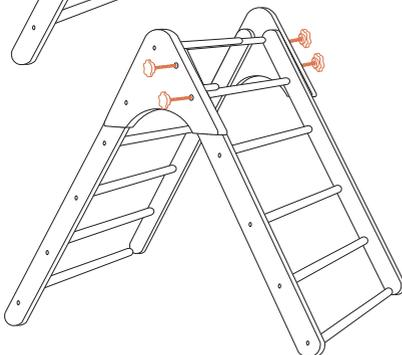
Finalmente enroscar los tornillos de sujeción para sujetar con la placa lateral.
