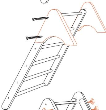
Acaba de atornillar con los tornillos más largos las dos varillas superiores junto con las placas laterales.
