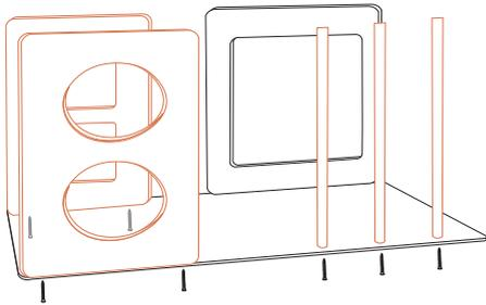
Añadir las piezas con las ventanas en ambos lados y atornillar tres varillas de manera vertical.
