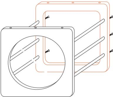
Se añade el otro lateral y se vuelven a atornillar las varillas en los agujeros de éste.
