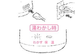
マグネットプラグを本体に接続し、電源プラグをコンセントに差し込みます。ランプが点灯して湯わかしを始めます。
