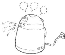
電源プラグやマグネットプラグの抜き差しは、湯わかし中にはしないでください。湯わかし中に抜き差しすると、スパークしてプラグをいためることがあります。
