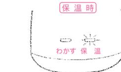
コードを接続すると、わかす ランプが点灯し、湯わかしを始めます。湯わかしが終わると、自動的に保温に切りかわり 保温 ランプが点灯します。保温を続けるときは、電源プラグを抜かないでください。電源プラグを抜きますと、徐々に湯温がさがります。
