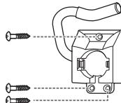
壁面にネジ(収納フック取付け用)3本で固定します。
