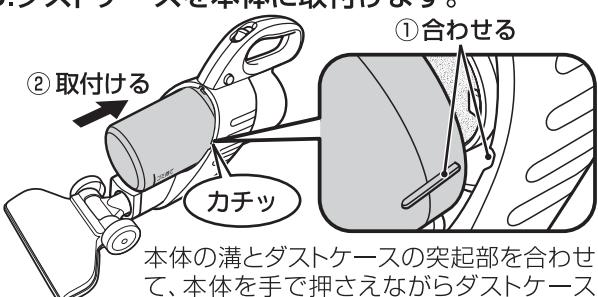
本体の溝とダストケースの突起部を合わせて、本体を手で押さえながらダストケース全体を押しつけるように「カチッ」と音がするまで確実に取付けてください。
