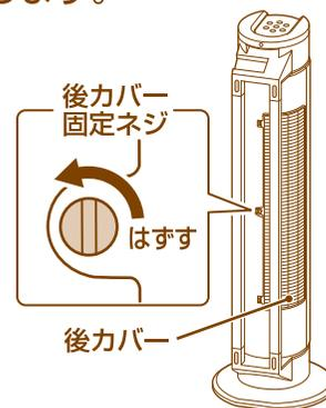
2. 後カバーのツメ(2箇所)を押しながら開いて、矢印の方向に引き抜きます。
