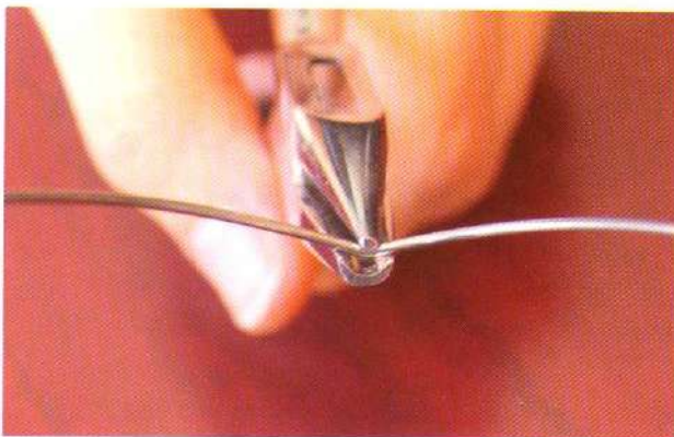
Doble del alambre con pinzas de media caña en la parte media
