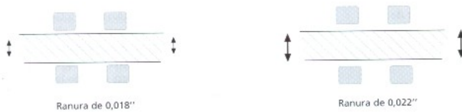
Fig. 1.21 La ranura de 0,022" permite una mayor libertad de movimiento a los arcos iniciales y facilita mantener las fuerzas ligeras.
