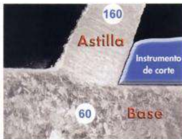
Figura 9-6 Una astilla muestra una dureza mayor en comparación con el bloque de metal.
