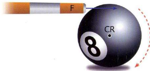
Fig. IX-4. Si la línea de acción de la fuerza pasa distante del centro de resistencia se genera una tendencia hacia la rotación del cuerpo.
