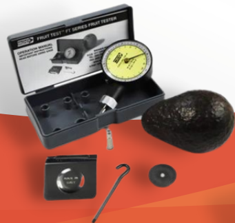
Penetrometro Portatil Punta 6mm para 20kg/200g Wagner FT40
