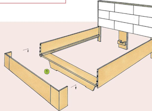
Fußteil bei beiden Bettseiten zugleich einhängen und mit Gummihammer abwechselnd links & rechts nach unten klopfen bis das Fußteil mit den Bettseiten bündig ist.
