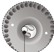
⑤安装密封圈时将分离式内锅盖边缘塞进密封圈背面槽子里,顺着密封圈背面槽子把分离式内锅盖塞进即可安装.
