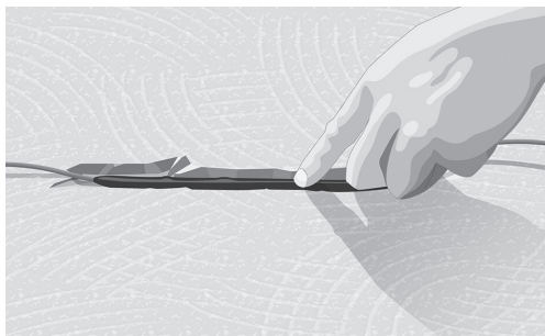
Рис. 2. Штроба для соединения нагревательного кабеля и соединительного провода
