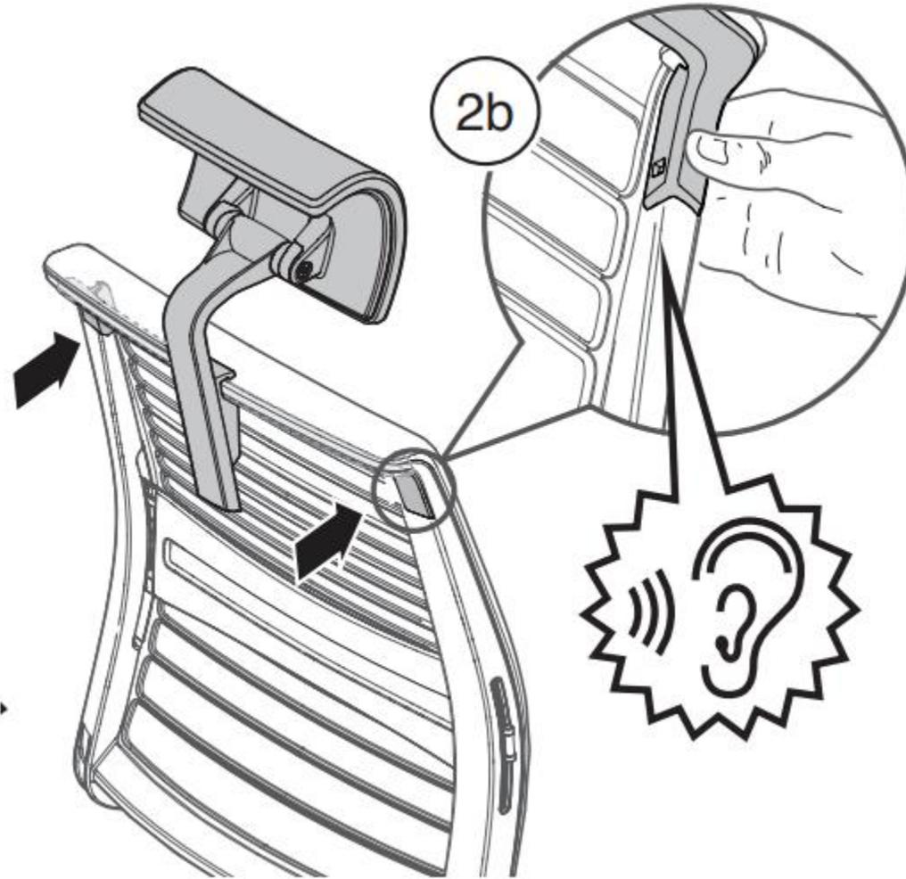
3)ヘッドレストを上下に動かし、クリック音がするかどうか確かめます。ヘッドレストがしっかりと装着されているか確認をします。
