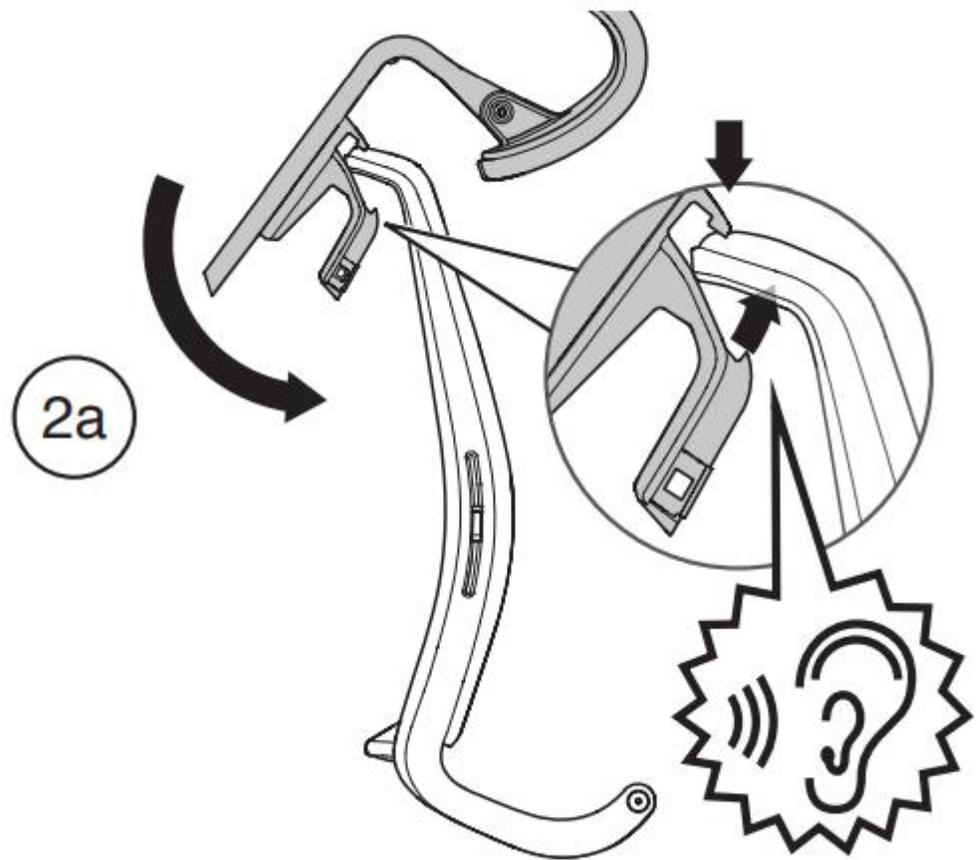
2b)押し込む事によって、「カチッ」という音がします。はまりましたら、フレーム全体を下から更に強く押し込みます。
