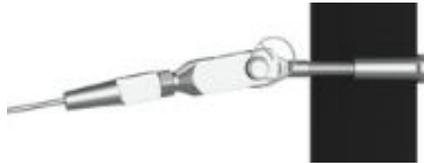
2. Assemblez le boulon et le manchon en vissant fermement. Pour terminer, fixez le tendeur voilier au boulon fileté. **ATTENTION! Laissez approximativement 10 filets de chaque côté du coeur du tendeur pour faire la mise en tension ultérieurement.**
