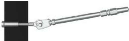
3. Insérez le câble dans l'embout et la clavette (pièce à l'intérieur de l'embout). Revissez l'embout et serrez fortement avec une clé 9/16".
