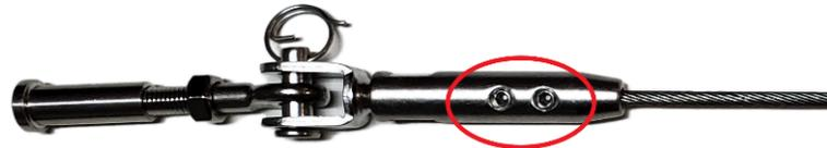
3. Coupez votre câble en mesurant la distance jusqu'à l'autre serre-câble rapide. Insérez le câble dans le serre-câble rapide et fixez fermement le câble à l'aide d'une clé hexagonale les deux vis hexagonales.
