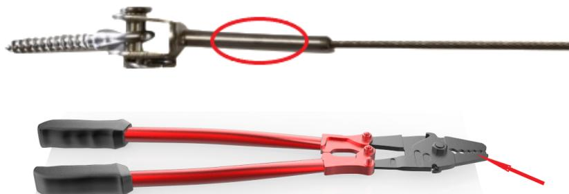
4. Coupez votre câble en mesurant la distance jusqu'à l'autre attache à sertir avec chape. Insérez le câble dans l'attache avec chape et sertissez l'embout à l'aide d'une pince à sertissage, en utilisant la matrice #2. Effectuez ensuite un deuxième sertissage en utilisant la matrice #1. Pour les longues distances, vous pouvez sertir trois fois la pièce.
