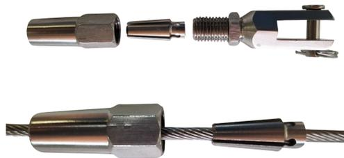
4. Coupez votre câble en mesurant la distance jusqu'à l'embout de l'autre attache classique. Insérez le câble dans l'embout et la clavette (pièce à l'intérieur de l'embout). Revissez l'embout à l'attache et serrez fortement avec une clé 9/16" et en maintenant l'attache.
