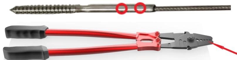
4. Coupez votre câble en mesurant la distance jusqu'à l'embout du tendeur. Insérez le câble dans l'embout et sertissez l'embout à l'aide d'une pince à sertissage, en utilisant la matrice #2. Effectuez ensuite un deuxième sertissage en utilisant la matrice #1. Pour les longues distances, vous pouvez sertir trois fois la pièce.
