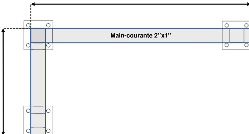
**C) Pour une structure avec 2 coins, positionnez les plaques aux extrémités des sections et mesurez la longueur des main-courantes de la façon suivante :**
