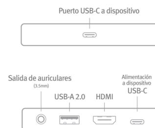
Nota: Si hay dispositivos conectados tanto al puerto HDMI como a la toma de 3,5 mm, el audio procederá de la toma de 3,5 mm. Si el StayGo mini ya está conectado al dispositivo, el audio procederá del último puerto conectado.
